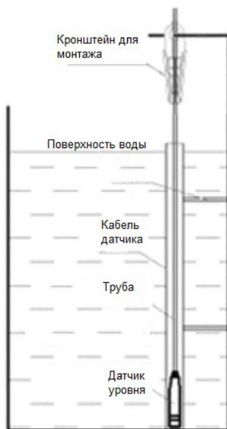
Установка в трубе
